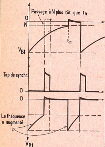
Fig. 5. — Processus de synchronisation par la base.
