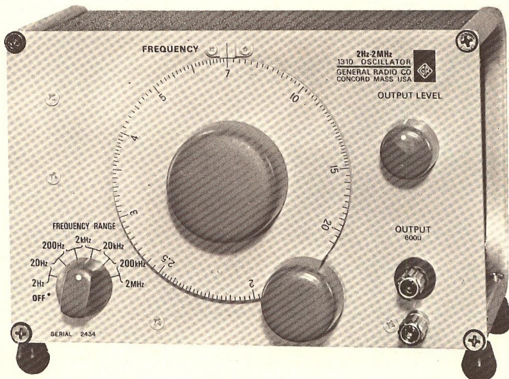
UN générateur basse fréquence est l'un des deux ou trois instruments indispensables lorsque l'on réalise le dépannage ou l'étude de matériels basse fréquence. L'utilisation en haute fidélité impose à cet appareil de mesure des performances les plus grandes quant à la pureté du signal délivré, le ronflement résiduel doit être faible, ainsi que le taux de distorsion harmonique.
