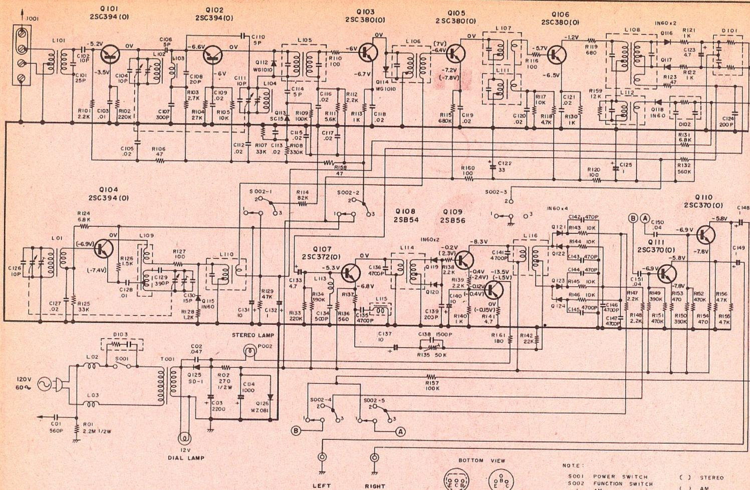
Q<sub>108</sub>. En présence du 38 kHz, la commande du voyant stéréo est déclenchée par le transistor Q<sub>109</sub>, fonctionnant en régime tout ou rien.
