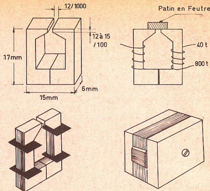
Fig. 3. — Exemple de construction d'une tête magnétique mono.
