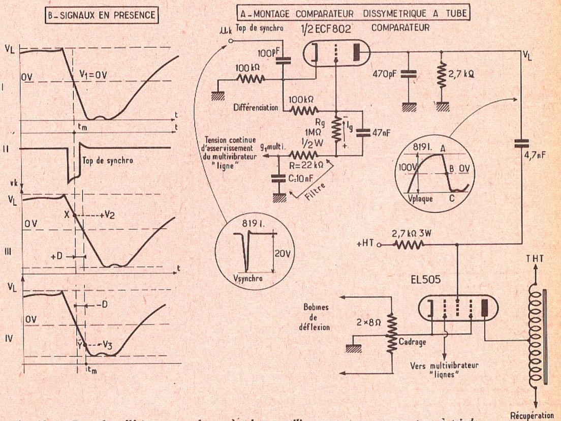
Fig. 10. — Dans les téléviseurs « couleur » à tube on utilise souvent un comparateur à triode.
