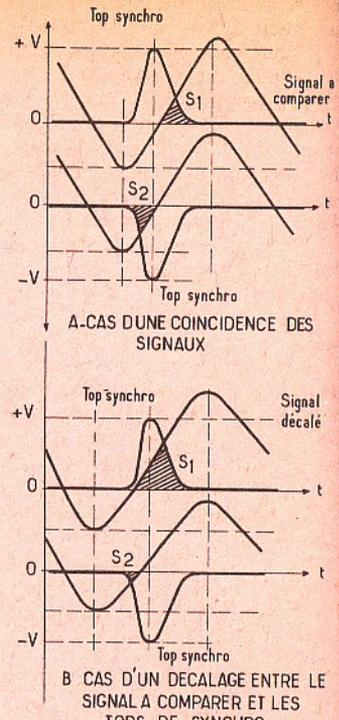
Fig. 8. — Analyse du fonctionnement du comparateur de phase.
