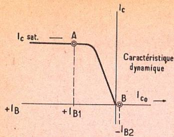
Fig. 3. — Fonctionnement en tout ou rien du transistor.
