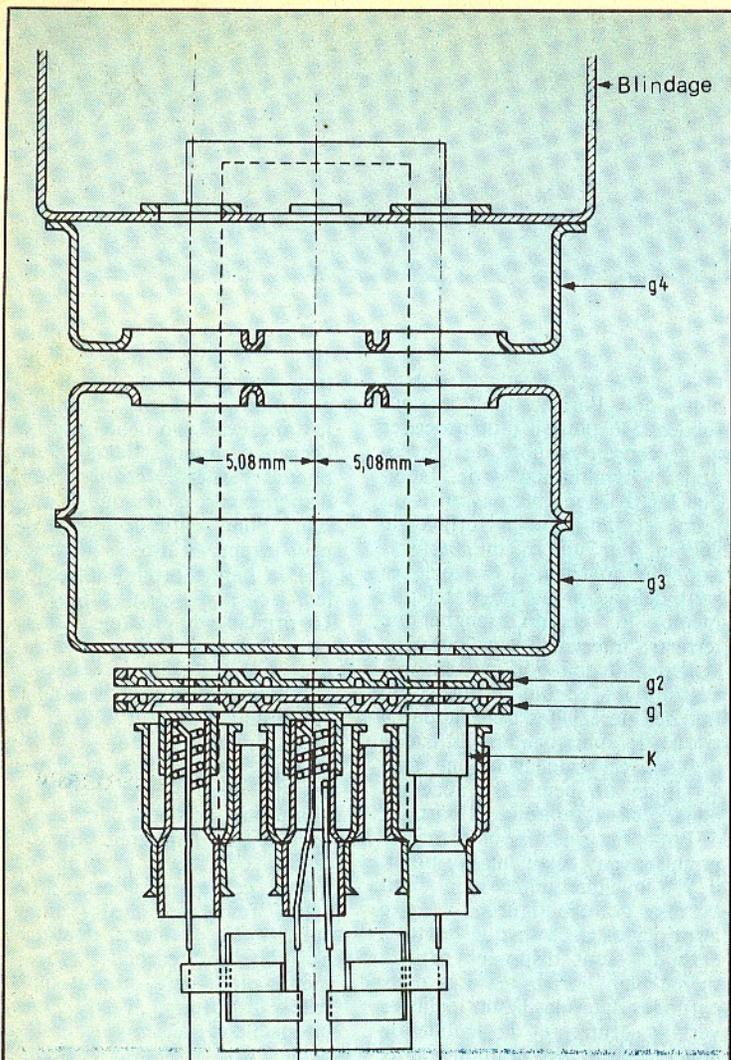
Fig. 4. — Dans le tube « In Line », les trois cathodes sont disposées parallèlement.
