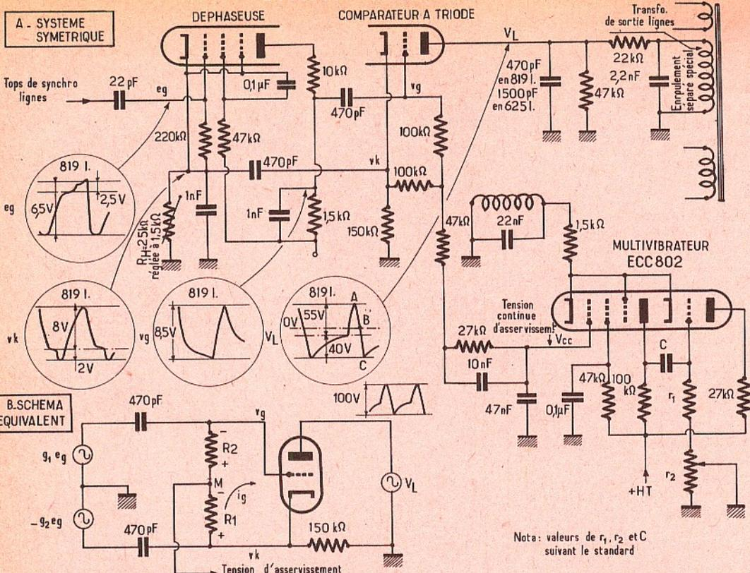
Fig. 11. — Montage comparateur symétrique à iode.
