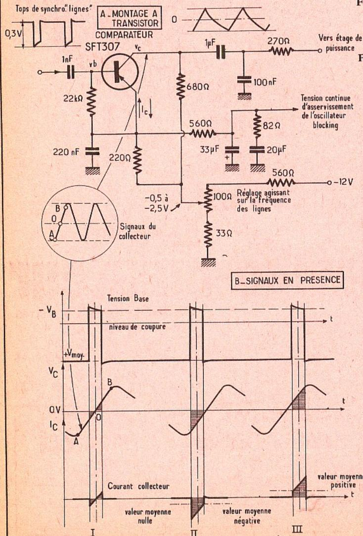
Fig. 12. — Comparateur à coïncidence à transistor bipolaire.
