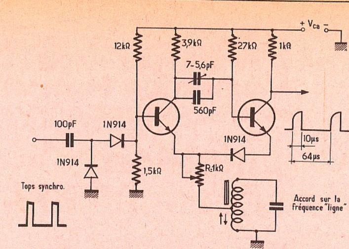
Fig. 6. — Exemple de multivibrateur à couplage d'émetteur.
