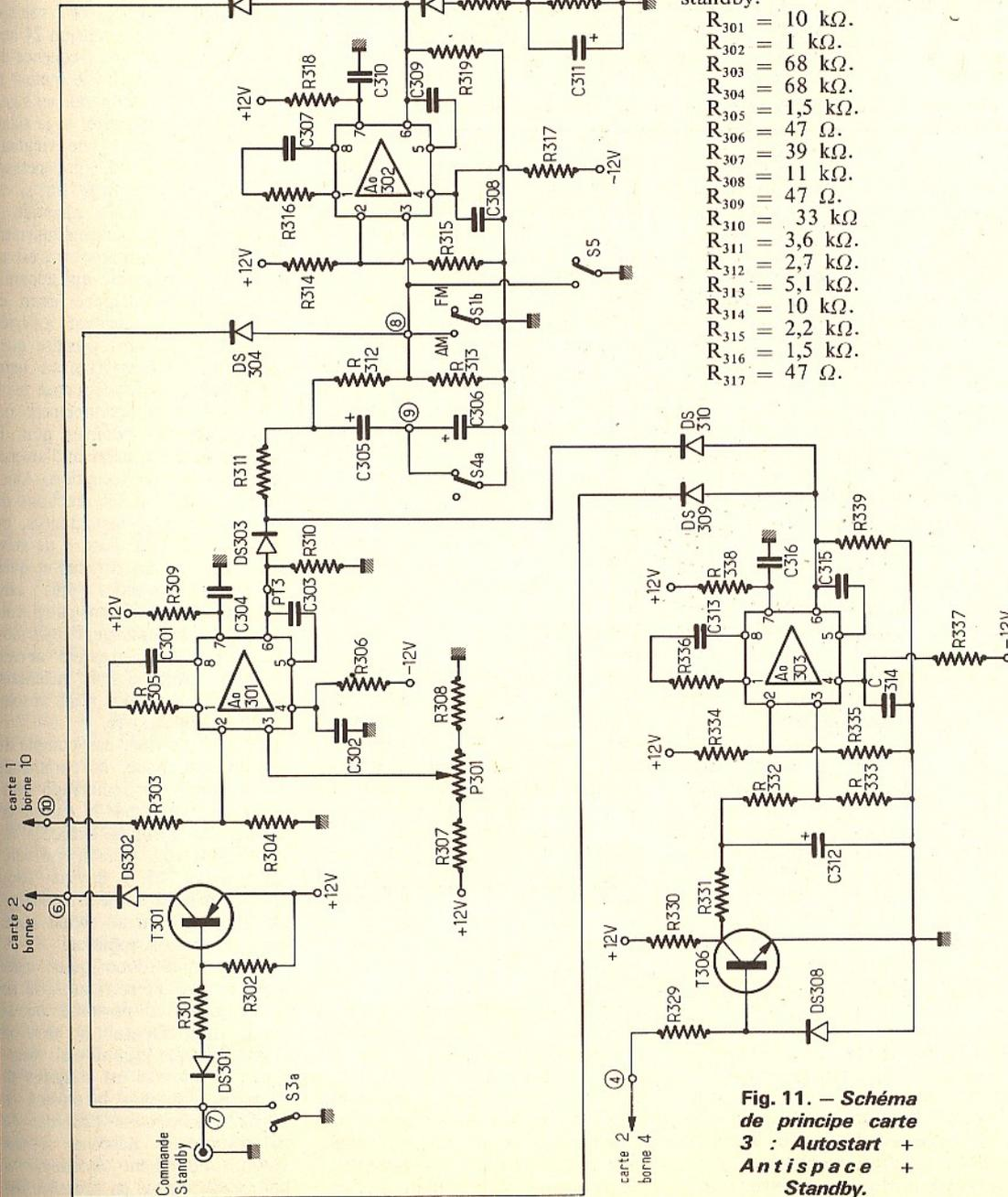
Fig. 11. — Schéma de principe carte 3 : Autostart + Antispacé + Standby.
