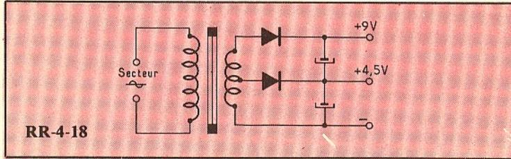
est représentée sur la figure RR-4.18 où nous avons : transformateur de 2x5 V eff. ; deux diodes de redressement et condensateurs de filtrage (2 000 à 5 000 µF). En charge d'utilisation, la tension redressée doit être de l'ordre de 2x4,5 V (soit 9 V au total).
