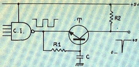
Fig. 5. — Façon d'obtenir des impulsions à partir des transitions négatives du signal rectangulaire en sortie de  $C_1$ . Quand celui-ci est positif  $C$  se charge par l'intermédiaire de  $R$ . Lorsque la sortie de  $C_1$  descend au potentiel de la masse,  $C$  se décharge à travers la jonction émetteur-base de  $T$ . Ce bref courant de base donne naissance, sur le collecteur, à une impulsion dont la forme et l'amplitude sont indiquées (ci-dessus).
