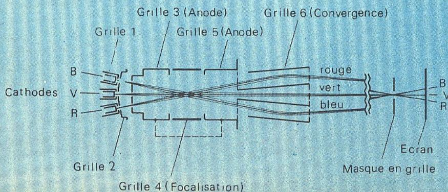
Fig. 3. — Disposition des électrodes du « Trinitron ».
