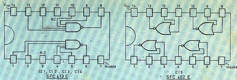
Fig. 8. — Branchement des différents circuits intégrés employés dans la partie impulsionnelle. Tous les boîtiers sont vus de dessus, côté opposé aux connexions.
