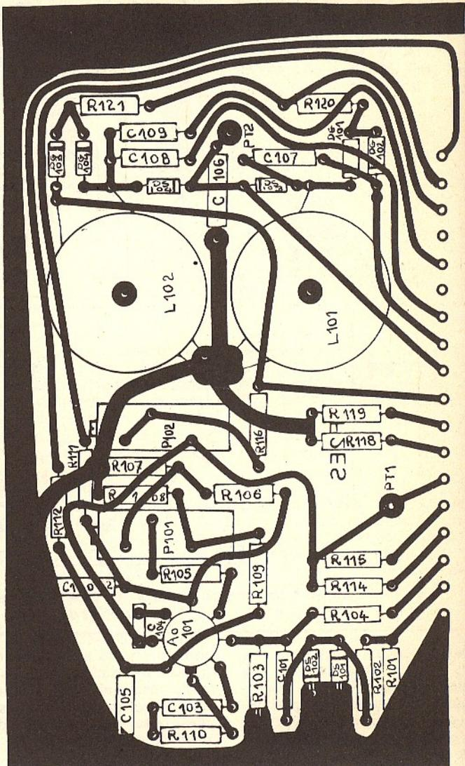
Fig. 17. — Branchement du LM709C (vue de dessus).
