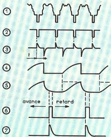
fréquence trame 50 Hz. Elles commandent un multivibrateur qui délivre des impulsions suivant l'oscillogramme 3. Les impulsions négatives retardées
