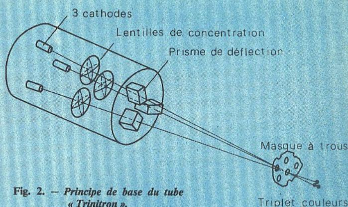
Fig. 2. — Principe de base du tube « Trinitron ».
