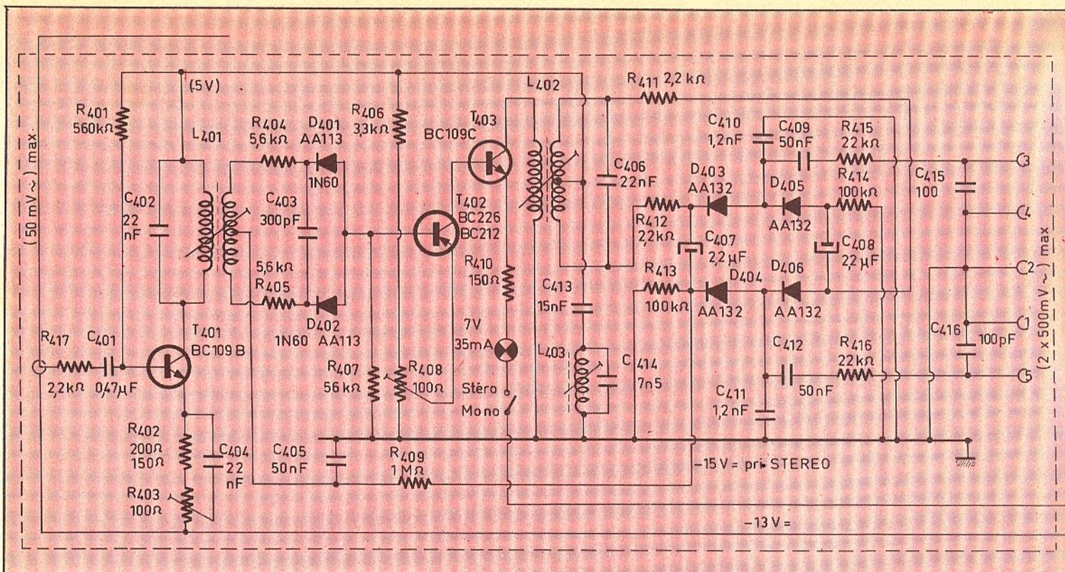
T<sub>1</sub> étant chargé par un circuit oscillant sur cette fréquence. L'enroulement secondaire doté d'un point milieu permet alors à l'aide des deux diodes D<sub>401</sub> et D<sub>402</sub> de former le doubleur de fréquence destiné à la restitution des canaux droit et gauche, grâce à la sous-porteuse à 38 kHz.
