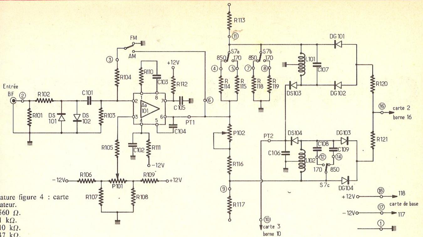
Fig. 4. - Schéma de principe carte 1 : Discriminateur.
